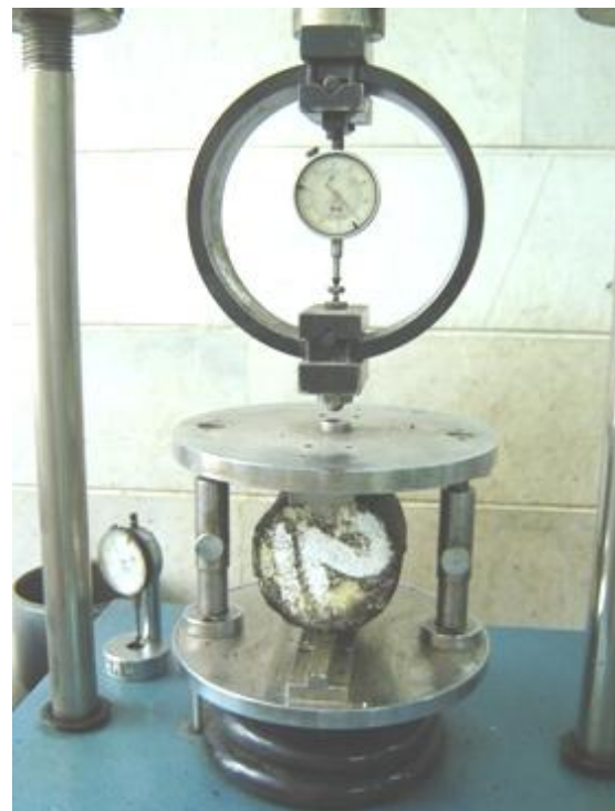
شکل ۵: دستگاه آزمایش مقاومت کششی غیرمستقیم
