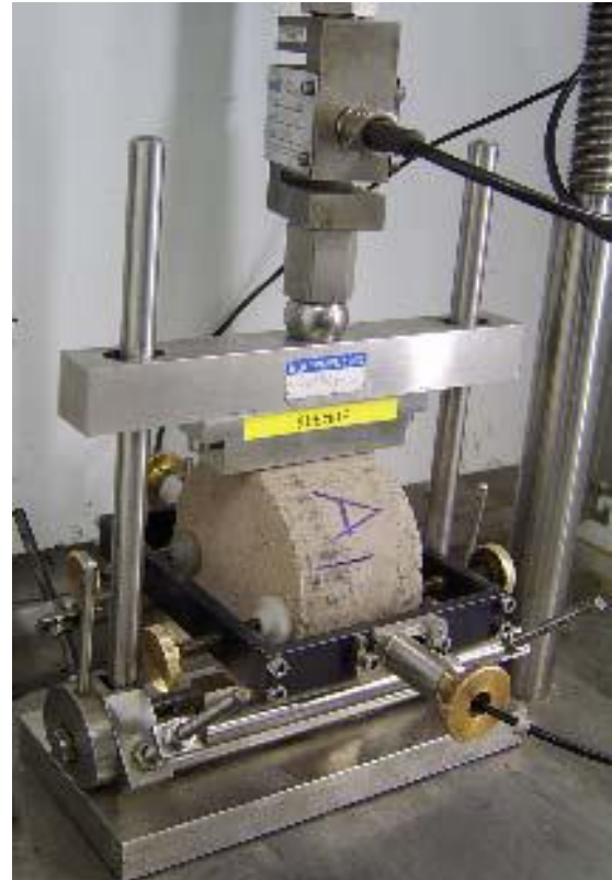
شکل ۴: دستگاه آزمایش مدول برجهندگی
