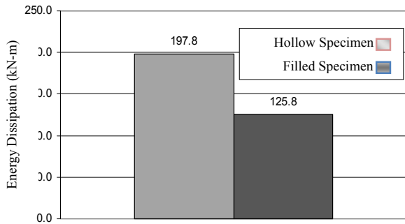
شکل ۱۳- مقایسه انرژی جذب شده نمونه‌های توخالی و پر شده با بتن 120 \times 120 \times 6
