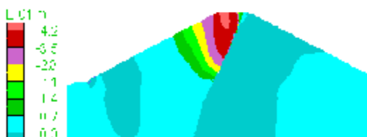
شکل ۱۳- الف: کنتورهای نشست پس از زلزله - سد با هسته مایل.
